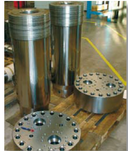
Bild 4: Auch größere Drehteile wie Kolbenstangen mit Zylinderdeckel fertigt Fa. Lauffer selbst
