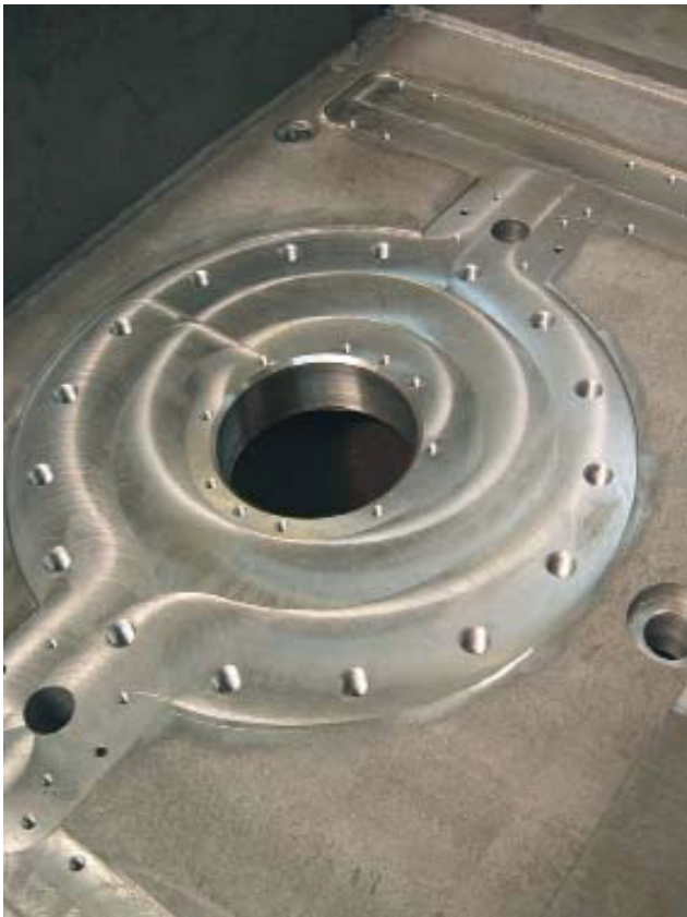
Bild 8: Die Fräs- und Bohrarbeiten an einem Pressen- stößel erfordern höchste Präzision bei stabiler Prozesssicherheit
