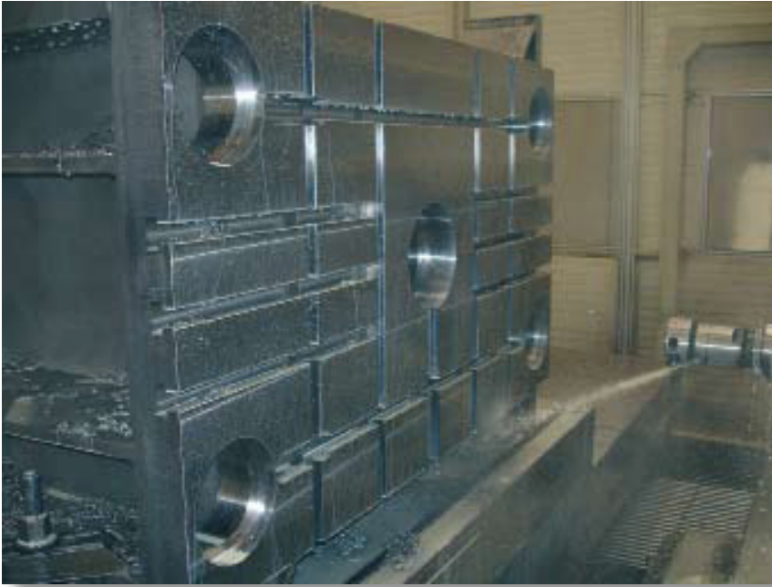
Bild 6: Komplexe Komponente: Pressenstößel mit T-Nuten und Säulenbohrungen für hydraulische Presse (bearbeitete Fläche: 1480 mm x 800 mm, UNION-Bohrwerk)
