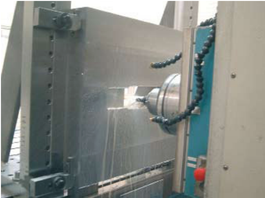
Bild 7: Mechanische Bearbeitung eines Pressen- stößes auf UNION-Bohrwerk
