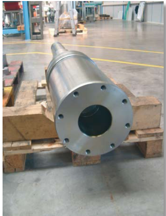
Bild 9: Mehrstufige Kolbenstange (Länge: 3000 mm) für hydraulische Presse, komplette Eigenfertigung im Hause Lauffer (Werkbilder: Georg Oest Mineralölwerk GmbH & Co. KG, Freudenstadt)
