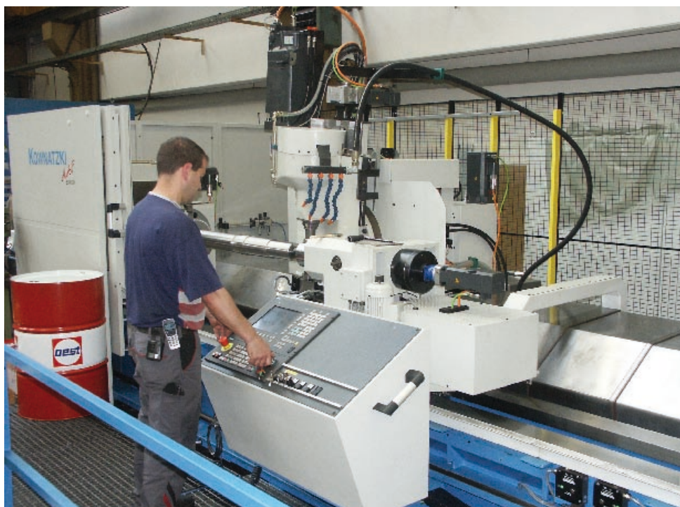
Auf der neuen, von Firmengründer Günter Kownatzki entwickelten Abwälz-Fräsmaschine können Werkstücke von einer Länge bis zu sechs Metern bearbeitet werden.
