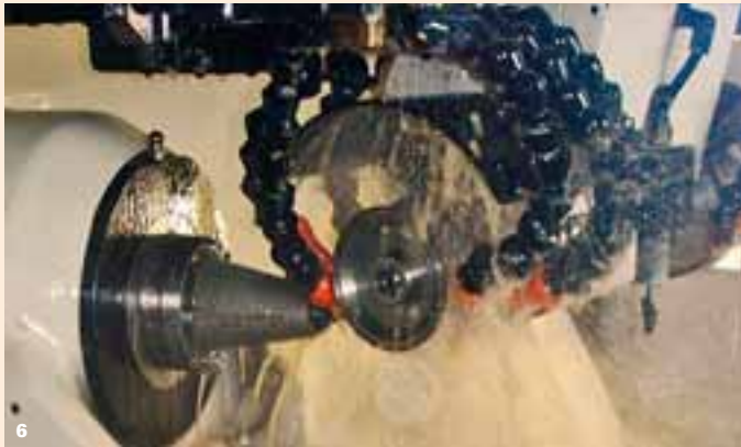
4 Zentrierspitze aus Vollhartmetall mit einer Spezialaufnahme.
