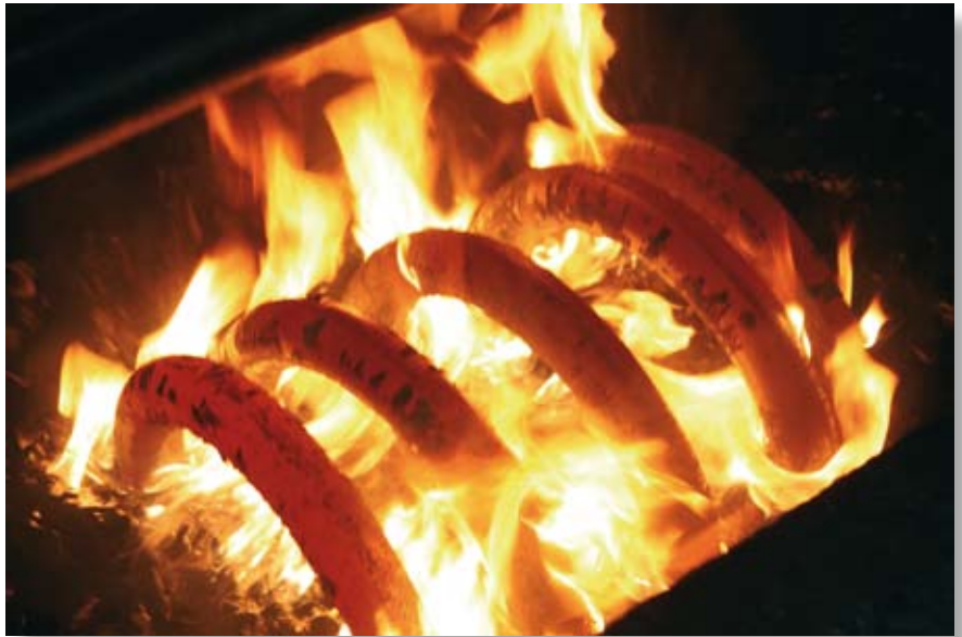
Bild 5: Speziell entwickelte Oest Härteöle kommen beim Härten der Grueber Federn zum Einsatz
