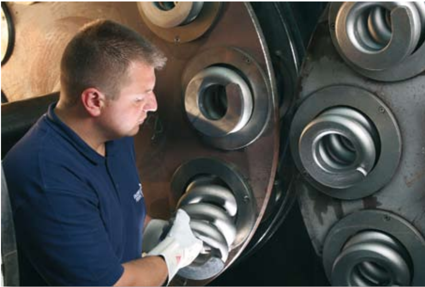
Bild 3: Die neue Schleifanlage verfügt über zwei Ladeteller für parallele Bearbeitung bzw. Beschickung und Entnahme
