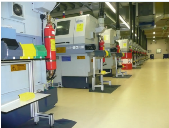
2 Blick in die Fertigungshalle von Altatec: Über 50 Langdrehautomaten und zwei Komplett-Bearbeitungszentren sind dort im Betrieb
