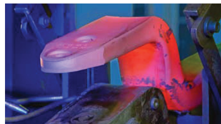
Automatische Entnahme aus dem Glühofen: Danach wird die Feder umgeformt und gehärtet.
