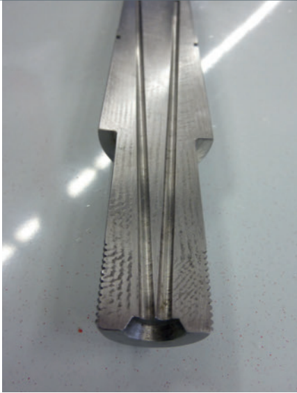
3 Mitschele realisiert auch schwierigste Werkstücke, zum Beispiel mit exzentrischen und schrägen Bohrungen für die Kraftstoffeinspritzung
