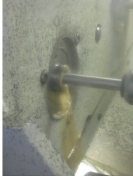
4 Beim Tiefbohrvorgang ist ein kontinuierlicher Ölfluss mit zuverlässiger Kühl-, Schmier- und Spülwirkung unverzichtbare Voraussetzung
