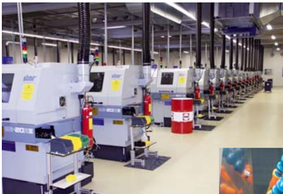
Blick in die Altatec Fertigungshalle, wo über 50 Langdrehautomaten und zwei Komplett-Bearbeitungszentren in Betrieb sind
