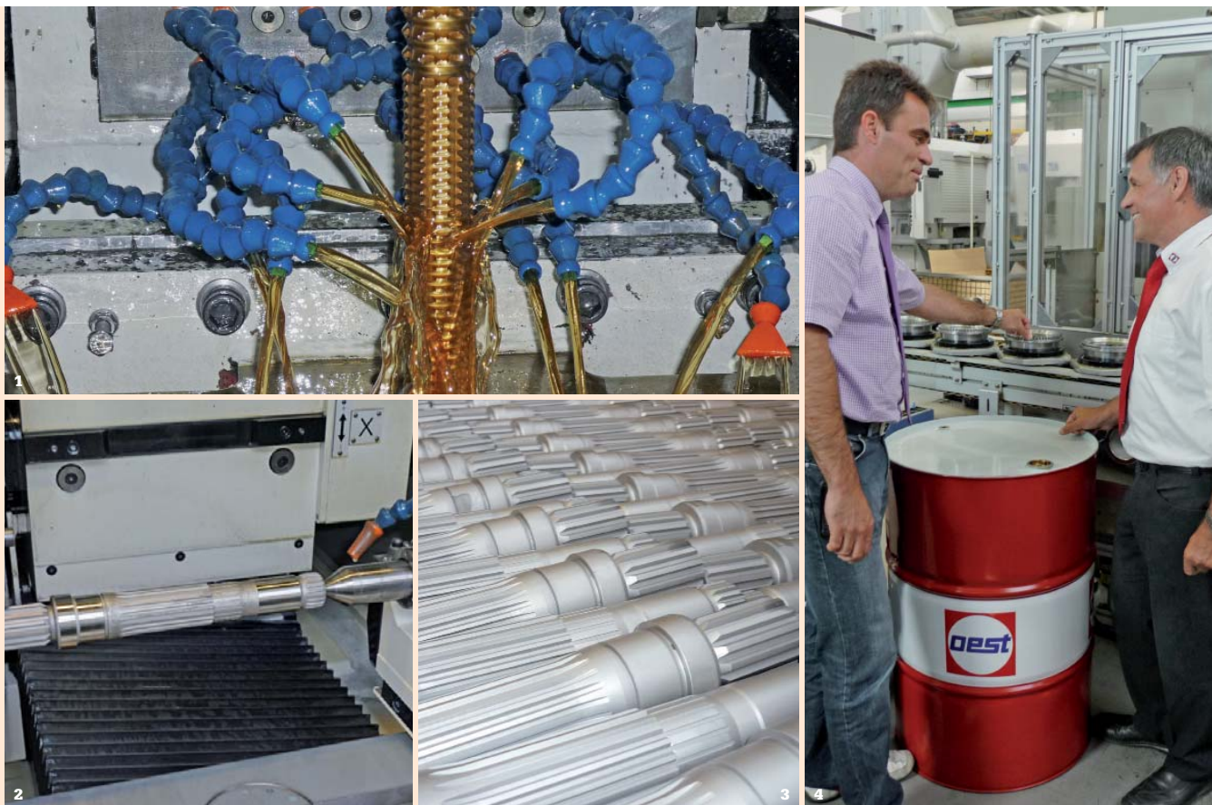
1 Dank des Oest EP-Schneidöls konnte die Standzeit der Räumnadel deutlich verlängert werden. 2 Die Herstellung verzahnter, komplett gehärteter und einbaufertiger Antriebswellen gehört zu den speziellen Kompetenzen von Dressler. 3 Gehärtete Antriebswelle beim Schleifprozess. 4 Geschäftsführer Uwe Dressler (links) und Oest-Gebietsverkaufsleiter Werner Lang sind regelmäßig in Kontakt, um die spanabhebenden Fertigungsprozesse zu optimieren.
