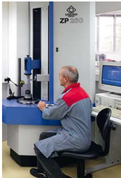
Bild 5: Hochwertige Messtechnik: Ein Klingelberg 3D-Verzahnungs- und Profilmesszentrum steht zur Verfügung
