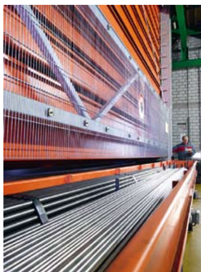
Bild 6: Das Rohmateriallager bietet viel Flexibilität: Grimm hat bis zu 300 Tonnen Material im direkten Zugriff (Werkbilder: Georg Oest Mineralölwerk GmbH & Co. KG, Freudenstadt)
