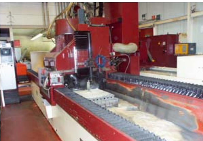
Beim Flach- bzw. Profilschleifen werden große Mengen an Kühlschmierstoff eingesetzt. Durch individuelles Fluid Management werden die Kosten reduziert und die Prozesssicherheit erhöht
