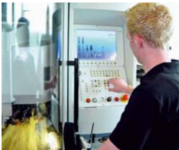
Tobias Gruber beim Einrichten eines 5-Achs-CNC-Bearbeitungszentrums
