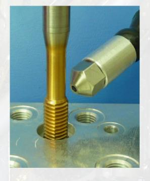
Oest Meba SP Sprühschmierstoffe werden mineralölfrei aus Komponenten formuliert, die in Anbetracht der minimalen Einsatzmengen ein Maximum an Schmierleistung bieten. Oest Meba SP Sprühschmierstoffe sind verträglich mit Bunt- und Leichtmetallen.
