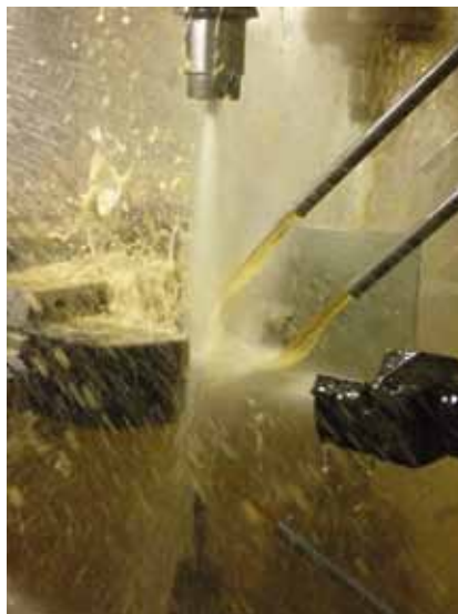
Bild 2: Bei der mechanischen Bearbeitung der Bauteile kommt ein universell einsetzbares Hochleistungs-Schneidöl der Oest Meba-Reihe zum Einsatz
