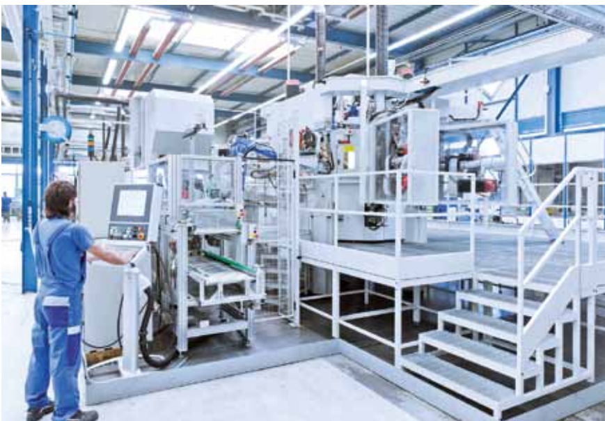
Bild 4: Auch auf der neu installierten Rundtackanlage wird das Schneidöl der Oest Mebra-Reihe erfolgreich eingesetzt
