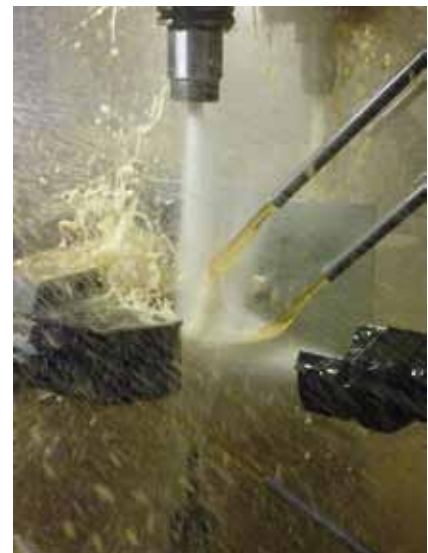
Bild 2: Bei der mechanischen Bearbeitung der Bauteile kommt ein universell einsetzbares Hochleistungs-Schneidöl der Oest Meba-Reihe zum Einsatz
