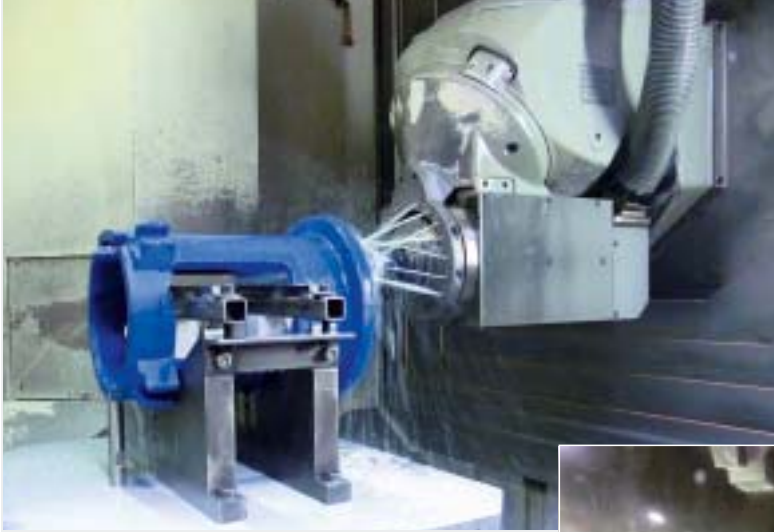
Fräsen eines Gussteils mit Oest Colometa
