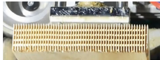
Lückenlose Klebstofflamellen durch partielle Nachbeimung.
