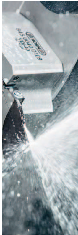
Ein- und Abstechen sind Bearbeitungsschritte, bei denen der KSS für den Abtransport der Späne wichtig ist. Bild: Horn
