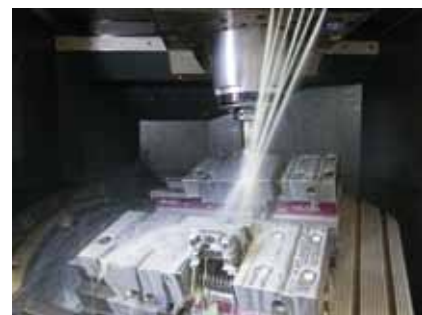
Bild 2 bis 4: Fräsbearbeitung eines Führungsgehäuses aus Edelstahl mit Oest Colometa
