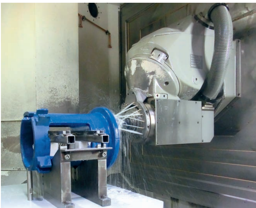
2 Fräsen eines Gussteils mit dem Allrounder Oest Colometa
