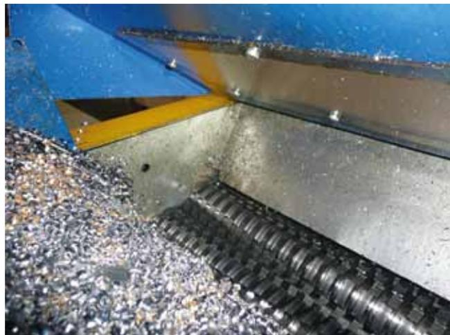
Bild 8: Ein HSM-Shredder beim Kompaktieren von Spänen
