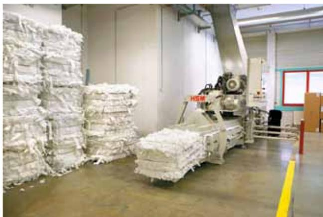
Bild 9: Vollautomatische und kontinuierlich arbeitende Kanalballenpressen von HSM dienen der Entsorgung von recyclingfähigen Produktionsabfällen in Großmengen
