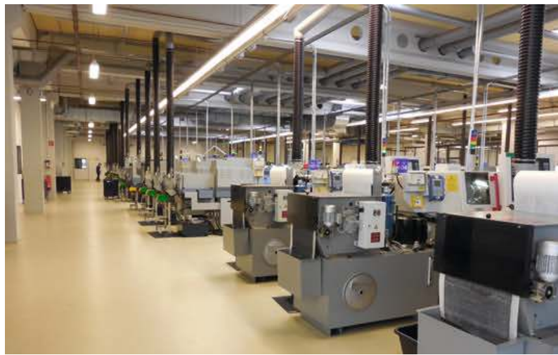
2 Eine der zwei Maschinenhallen bei Altatec. Insgesamt mehr als 60 CNC-Langdrehautomaten fertigen ein Teilespektrum von 1200 unterschiedlichen Artikeln
