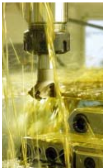
Bei der mechanischen Bearbeitung der Bauteile kommt ein universell einsetzbares Hochleistungs-Schneidöl der Oest Meba-Reihe zum Einsatz (links)
