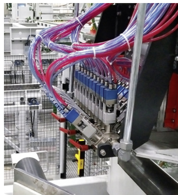
Der Oest-Auftragskopf Profitac VN arbeitet nach dem „All in use“-Prinzip
